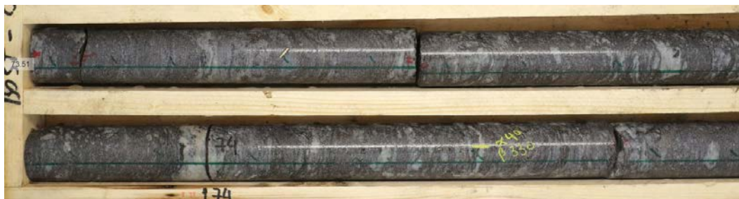
Photo 1 : Carotte de forage au diamant de taille HQ3 (61 mm) de la foreuse.
