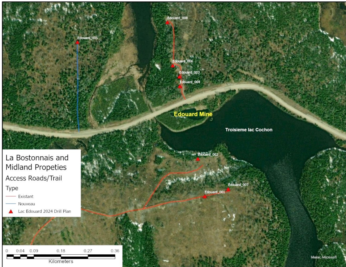
Carte 1 : La region de la mine de Lac Edouard. Triangles rouges sont des aires de forage. Routes a déneiger en rouge et nouvelle route à déboiser en bleu.
