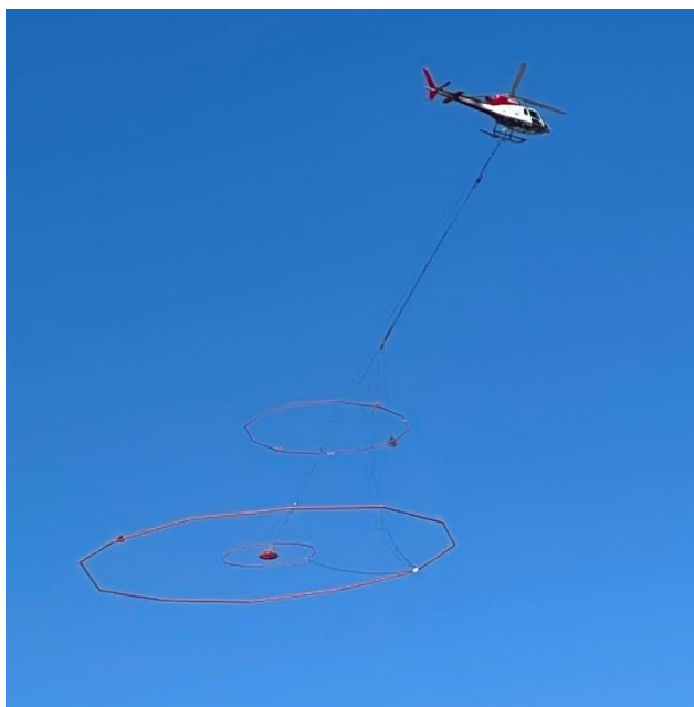
Équipement de levés électromagnétiques géophysiques par hélicoptère.
